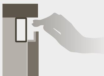
**6 <it>** La presa Frame nasce dall'integrazione sulla presa Step di un profilo in Alluminio Opaco o Titanio. **<en>** The Frame grip edging consists in adding an Alluminio Opaco or Titanio moulding to the Step edging. **<fr>** La prise de main Frame naît de l'installation d'un profil en Alluminio Opaco ou Titanio sur la prise de main Step. **<es>** El tirador acanalado Frame nace de la integración del tirador acanalado Step con un perfil
