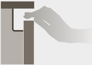
4 – **it** La gola ad "L" in alluminio permette una comoda apertura dell'anta. **en** The L-shaped aluminium grip recess allows the doors to be opened easily. **fr** La gorge en «L» en aluminium permet d'ouvrir la porte en toute aisance. **es** La ranura en "L" de aluminio permite que se abra cómodamente la puerta. **de** Die „L-förmige“ Hohlkehle aus Aluminium ermöglicht das bequeme Öffnen der Tür. **ru** Г-образная алюминиевая голя позволяет удобно открывать створку.
